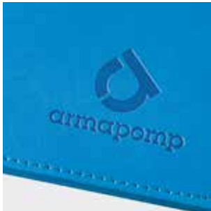
Tłoczenie na sucho
